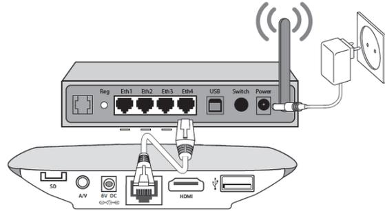
2. Falls der Fernseher über einen HDMI-Eingang verfügt (die meisten neueren Geräte): Die Set-Top-Box mittels einem HDMI-Kabel (nicht im Lieferumfang enthalten) mit dem Fernseher verbinden.
